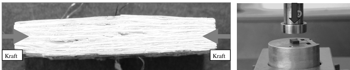
Abb. 6: Druckprobe, die die Versagensmechanismen nach der Belastung zeigt (links) sowie Druckprüfungseinrichtung mit justierbarer Probenführung zur Verhinderung vorzeitigen Ausknickens der Probe (rechts)
